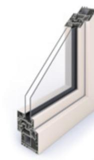
**Connessione.** Profilo in pvc con telaio a tripla guarnizione, telaio ed anta di spessore 82 mm, profilo anta a 7 camere con rinforzi in acciaio.
