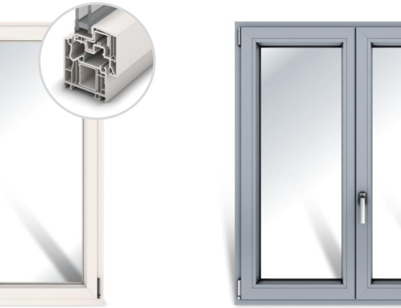
versi stili abitativi, soprattutto ai più soli in pvc estruso di classe A e mescole (eri), Icon garantisce un isolamento superiore. La tripla guarnizione di battuta garantisce una tenuta perfetta, mentre il telaio è composto da 2 camere e l'anta con profilo a 6 camere garantisce una maggiore stabilità e sicurezza.
