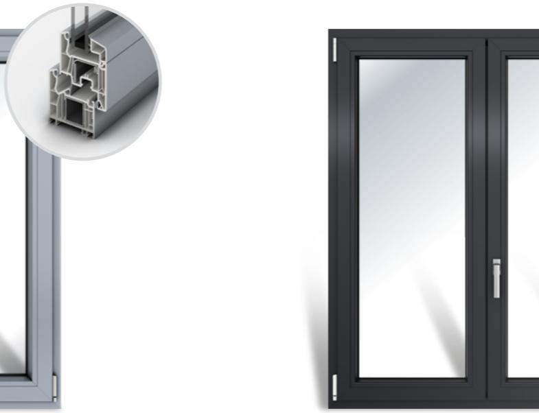
serramenti in PVC. Profilo con anta a 5 camere con rinforzi in tonici fino a 48 mm di spessore. E' antieffrazione certificata RC2 a-ribalta a forare e chiusura a chiavi di 120 kg nelle porte finestre e serrriere a scomparsa.
